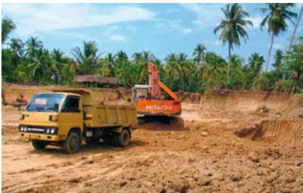
»1 Typical clay winning in the region around Banda Aceh »1 Typische Tongewinnung in der Umgebung von Banda Aceh
