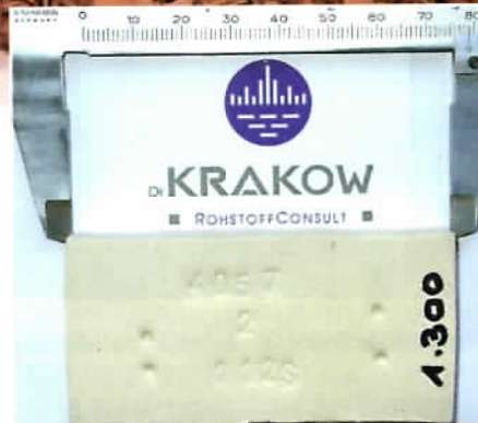
Zukunftsweisende Technik – Filterkuchen aus modernen Membranfilterpressen.
