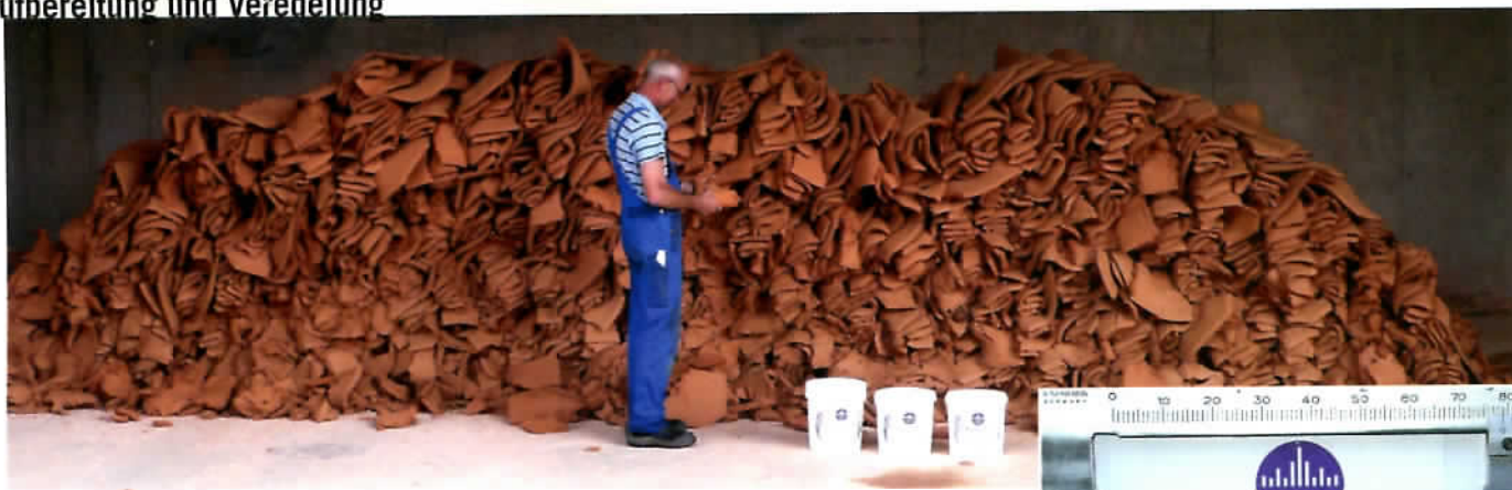
Kaolinschlamm kann ohne jegliche Zusätze keramisch gebrannt werden.
